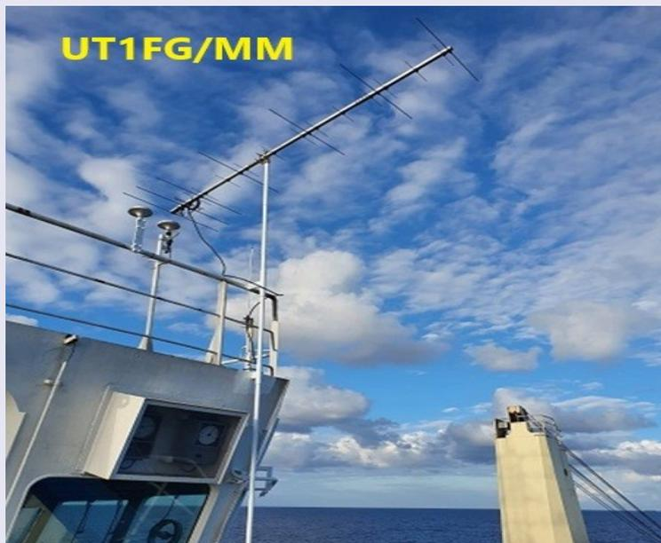
**Yuri, UT1FG** travaille sur un navire commercial et était Maritime Mobile entre Cuba et la Floride dans le localisateur de grille EL94PC. Il exploitait 200 watts pour former une seule antenne Yagi à 7 éléments.
