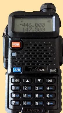
Le Baofeng UV-5R L'échantillon de radioamateur (Certified) que nous avons testé a bien fonctionné dans ses deux bandes. Nous n'avons mesuré aucune émission parasite dépassant les niveaux autorisés par les directives de l'UIT.
