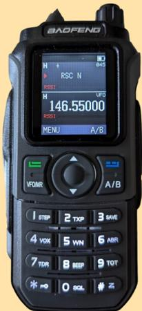
La performance du Baofeng UV-21 l'échantillon de radioamateur que nous avons testé présentait une variabilité significative en fonction de la bande de fréquences de fonctionnement. Il a généré de multiples émissions parasites au-dessus de la bande fondamentale de 2 m (144 MHz) qui n'étaient pas conformes aux directives de l'UIT pour de telles émissions.
