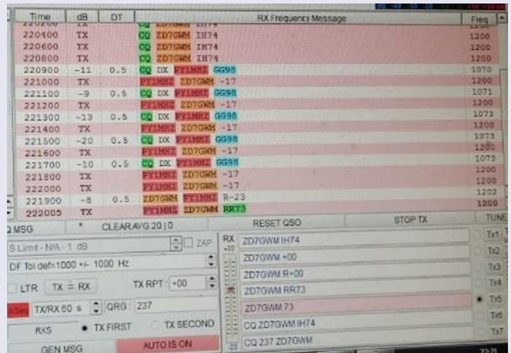
Garry utilisait une antenne verticale Diamond X700 et environ 50 w. De mon côté, j'utilisais 8 éléments verticaux avec 200 w. Je pouvais travailler jusqu'à 500 w mais il n'y avait pas besoin. Très content de ce cadeau de Noël.73 de Marcos PY1MHZ en grille GG98LC
