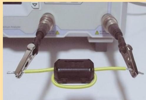
Il s'agit d'un résultat très intéressant montrant que le seul tour supplémentaire à travers le noyau augmente l'absorption de -4,4 dB à un énorme -12,41 dB.
