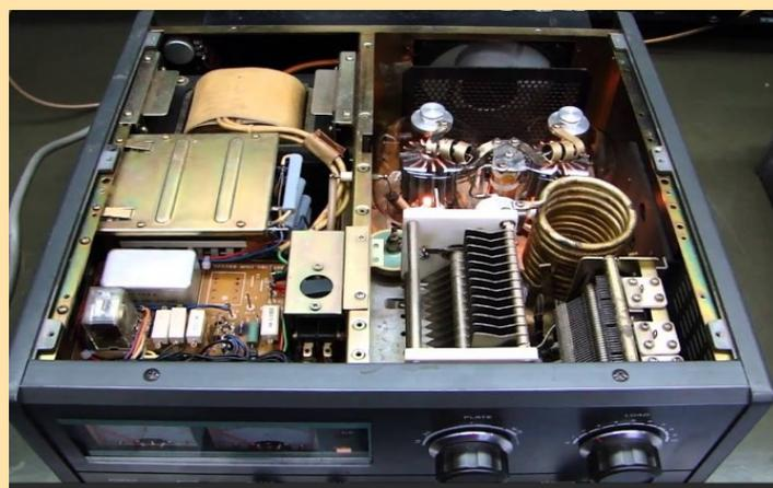
L'ampli linéaire **Kenwood TL-922A** HF est conçu pour fournir la puissance légale maximale, en utilisant deux tubes de transmission haute performance 3-500Z.
