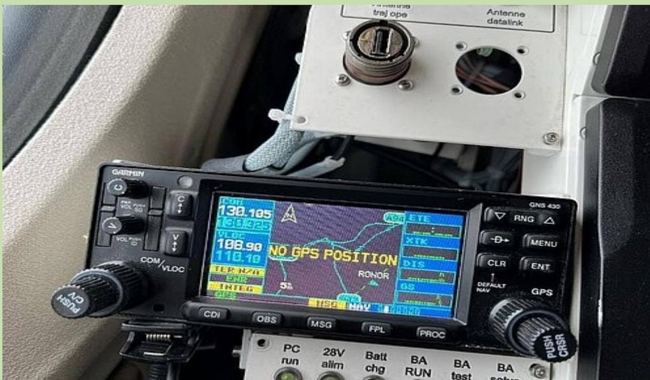
Récepteur GNSS dans l'avion de la DGAC le 21 mars 2023 lors des mesures en présence d'un brouillage du GNSS
