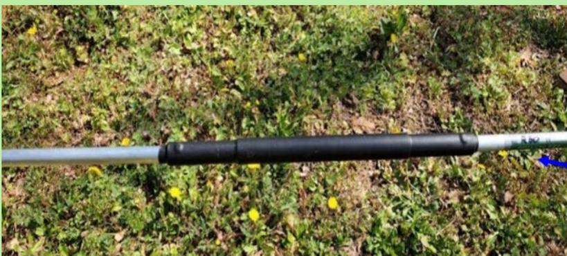
2 radiants 40 et 2 radiants 30 mètres Ceux-ci sont "raccourcis" par "bobinage"
