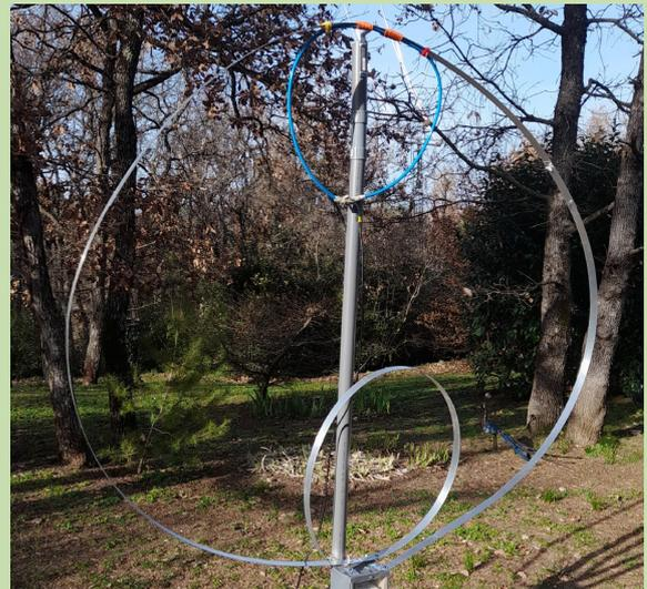
Antenne loop magnétique sur 7 MHz
