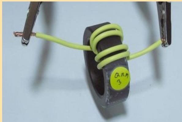
Certes, il reste suffisamment de place pour ajouter encore plus de bobinages, mais l'escalade rapide de l'absorption HF devient très évidente à partir de seulement quatre tours.
