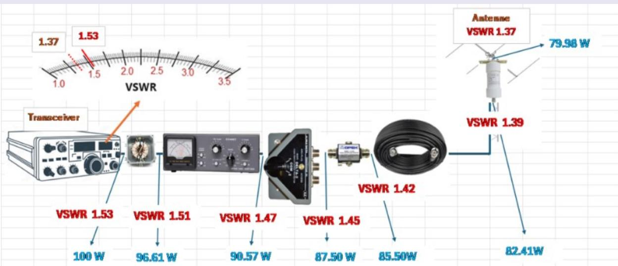
A partir d'un VSWR d'antenne de 1.37, la lecture finale (la plus réaliste) serait de VSWR 1.53. Nous pouvons également apprécier la chute de puissance au fur et à mesure que l'on se rapproche de l'antenne. Source : KJ4EGU
