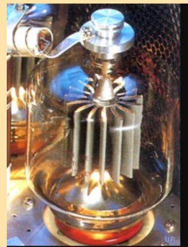
La **3-500Z** est une triode de puissance très fiable et efficace pour les applications d'émetteur-récepteur.
