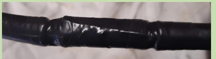
Il en est de même si l'on doit raccorder un gros câble 1/2 pouce à 7/8° de pouce: dans ce dernier cas, l'âme fait 8mm de diamètre! Réaliser une réduction conique en cuivre sur environ 20 mm de longueur pour passer de 8mm aux < 2mm de l'âme d'une bretelle en RG214. Le diélectrique aura le même aspect conique ainsi que le clinquant assurant la réduction du diamètre des tresses.
