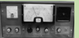
Récepteur G 4/215 (1962) RX AM, CW, 0.5 à 31 MHz
