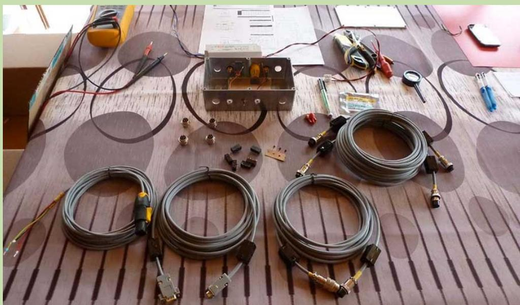
Toutes les extrémités des câbles de liaison sont équipées d'un tube en ferrite pour résorber les parasites dus aux rayonnements radioélectriques. Il est facile de trouver des modèles de ferrite à « clipser » sur une extrémité de câble.
