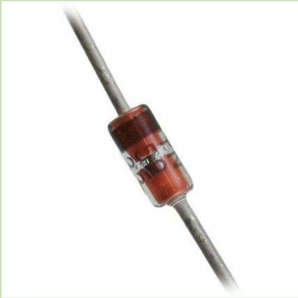
Diodes 1N4148 à placer en antiparallèle sur les bobines d'excitation des relais.
