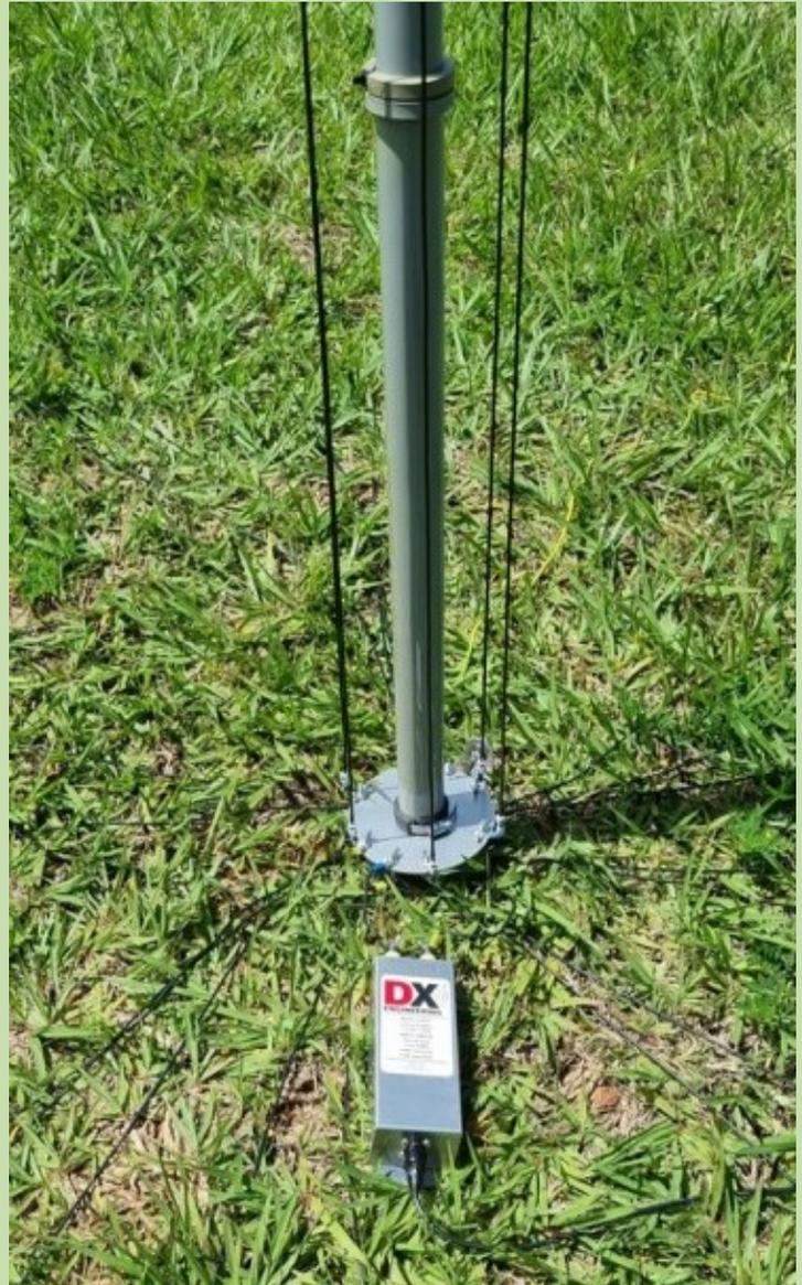
**Le DX Commander** utilise un système de radiateurs télescopiques en fibre de verre, qui peuvent être ajustés pour différentes bandes, ainsi qu'un système de contre-poids en fil pour une meilleure efficacité. Cette antenne peut être montée sur un mât ou un support de montage, et est conçue pour être facilement démontable et portable. Le DX Commander est conçu pour être utilisé avec un tuner d'antenne pour une adaptation optimale sur chaque bande.
