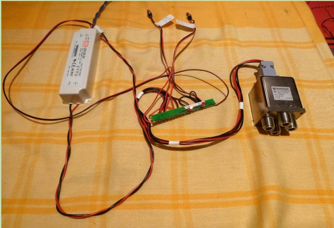
Setup de test du relais coaxial transfert switch, modèle TN6V24 Ducommun. Le basculement sur la 1<sup>ère</sup> et 2<sup>ème</sup> position s'effectue par impulsion au moyen de deux boutons poussoirs distincts. Le contact Indicator est raccordé sur deux LEDs distinctes.
