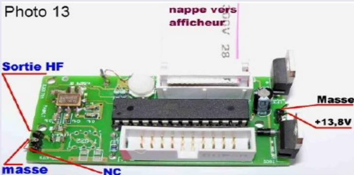
Lorsque vous avez terminé d'assembler tous les composants sur le circuit imprimé, souder le SI570 CMOS en prenant toutes les précautions antistatiques, souder fer débranché, avoir bien vérifié les soudures, brancher le + 13,8 V comme indiqué et le -13,8V à la masse. Sans oublier de connecter l'afficheur et sa nappe.
